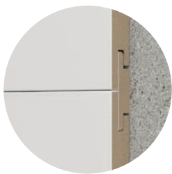
2 Принцип соединения панелей между собой
