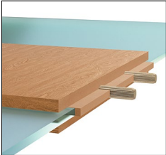
Толщина поперечных элементов 22мм
